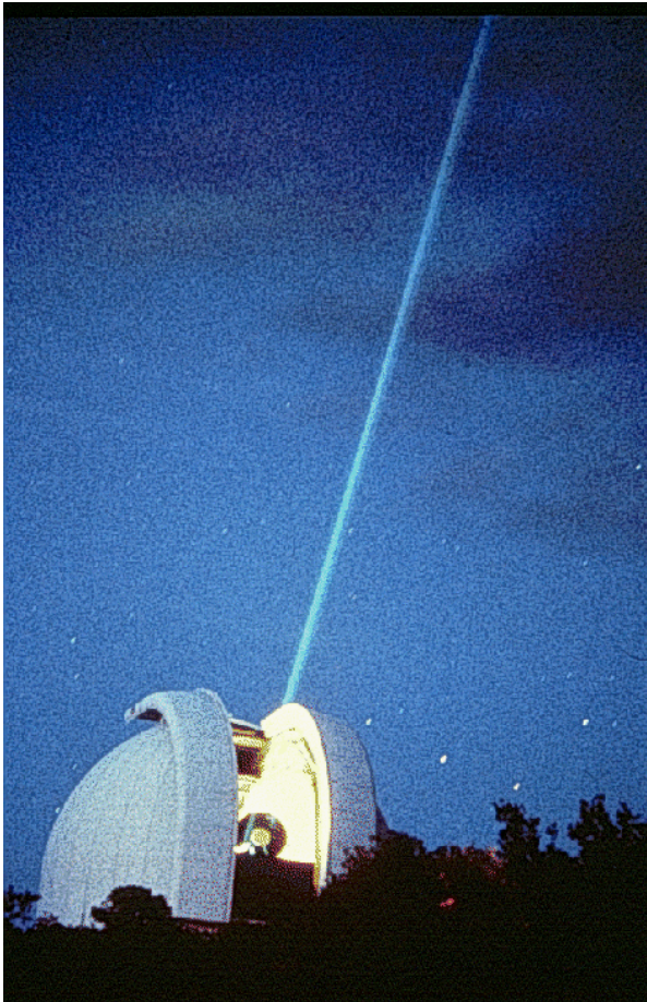
Figuur 1. Een laserstraal uitgezonden vanuit een observatiestation wordt gebruikt om de afstand Aarde – Maan nauwkeurig te meten.
